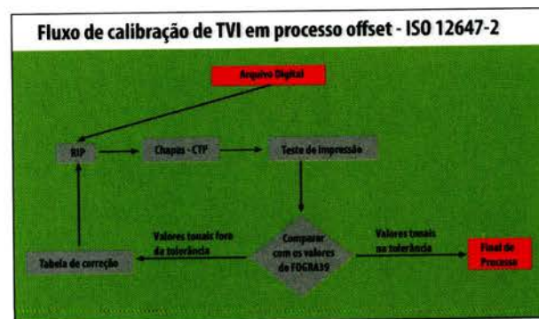
Fig.5- Fluxograma de trabalho para a calibração segundo a ISO 12647-2
