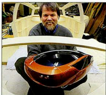
Veículo Urbee, com carroceria fabricada por impressão 3D
